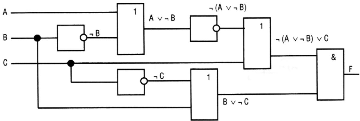
Обратите внимание, что на вход логической схемы подаются все сигналы (A, B, C), участвующие в логической функции, в не инвертированном виде. Количество входов логической схема равно количеству переменных, участвующих в логической функции, а выход всегда один.
