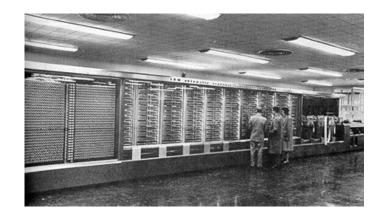
Основная идея заключалась в физическом разделении линий передачи команд и данных, поэтому процессор мог считывать очередную команду и оперировать памятью данных одновременно и без использования кэшпамяти.
